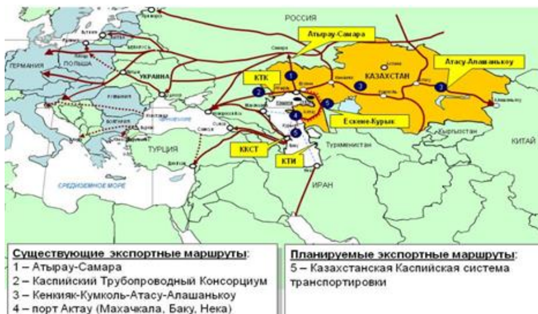
Рисунок 1– Нефтепроводная система Казахстана
